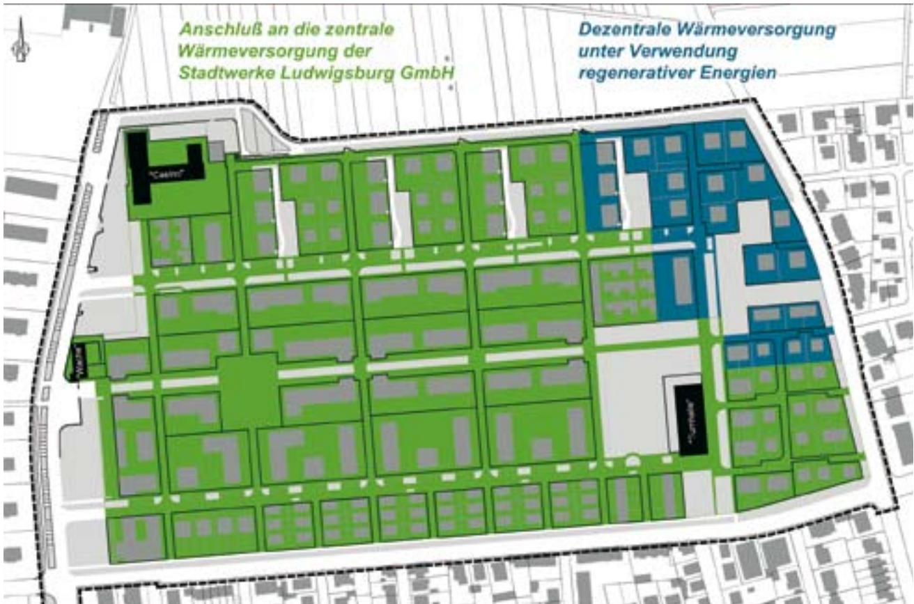
Abb. 3.7: Energiekonzept, Wärmeversorgungsgebiete. Energieplanung: EGS-plan, Stuttgart
