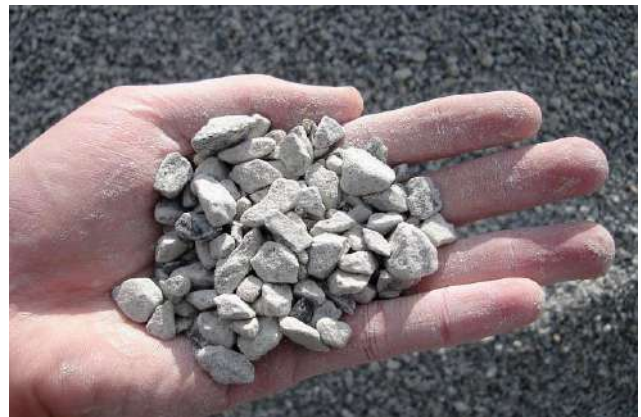
Straßenschotter, Auffüllung , maschinell kantig gebrochen. Emadrazo , Gravel 03375C , bearbeitet, CC BY-SA 4.0
